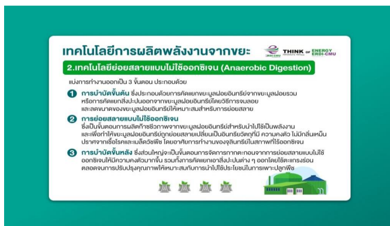
ภาพ 8 การทำงานของเทคโนโลยีย่อยสลายแบบไม่ใช้ออกซิเจน (Anaerobic Digestion)
