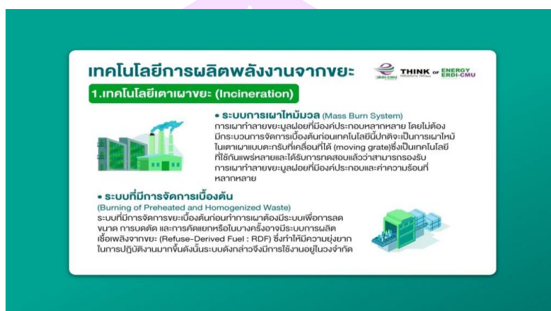
ภาพ 7 การทำงานของเทคโนโลยีเตาเผาขยะ (Incineration)
